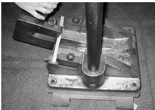
Figura 7. Pêndulo de Charpy. Figure 7. Charpy's pendulum
