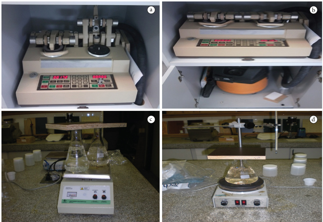
Figura 1. (A) e (B) Ensaios de abrasão; (C) e (D) Ensaios de absorção de vapor. Figure 1. (A) and (B) Tests of abrasion. (C) and (D) Tests of vapor absorption.
