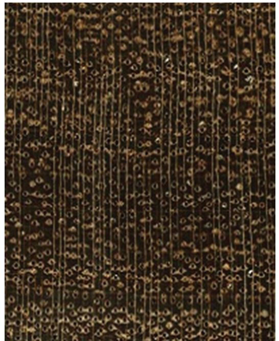
Figura 7. Fotomicrografia da madeira de Zeyheria tuberculosa – plano transversal, 10×.
