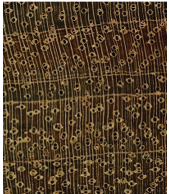
Figura 8. Fotomicrografia da madeira de Hymenaea courbaril – plano transversal, 10×.
