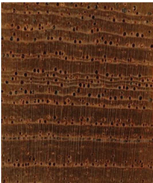
Figura 2. Fotomicrografia da madeira de Cedrela fissillis – plano transversal, 10×.
