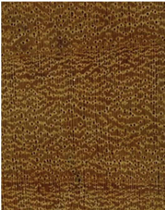
Figura 6. Fotomicrografia da madeira de Apuleia leiocarpa – plano transversal, 10×.
