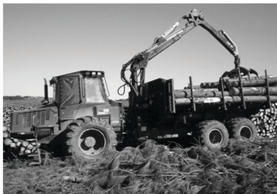
**Figura 1.** Harvester e forwarder utilizados na colheita de madeira.
