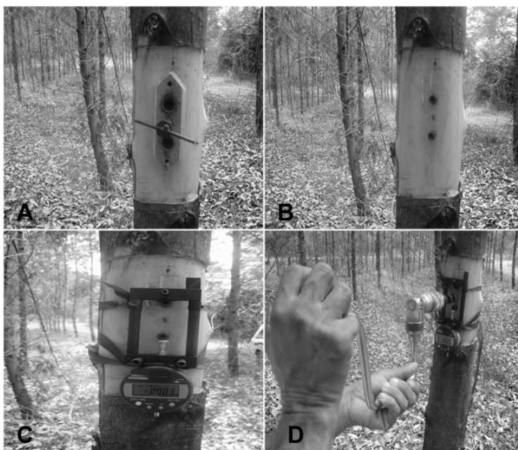
Figura 1. Medição da deformação residual longitudinal (DRL): (A) Fixação dos pinos a distância de 45mm com o auxílio de um gabarito; (B) Pinos fixados ao tronco; (C) Ajuste do relógio digital apoiado nos pinos; (D) Uso do arco de pua para liberar as tensões.
